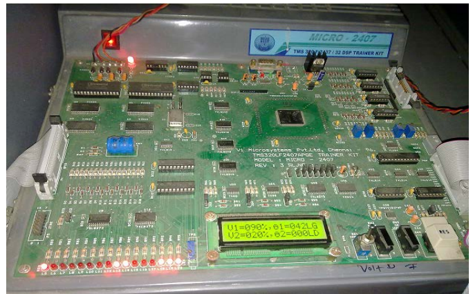
Fig. 6: DSP Trainer TMS320F2407
